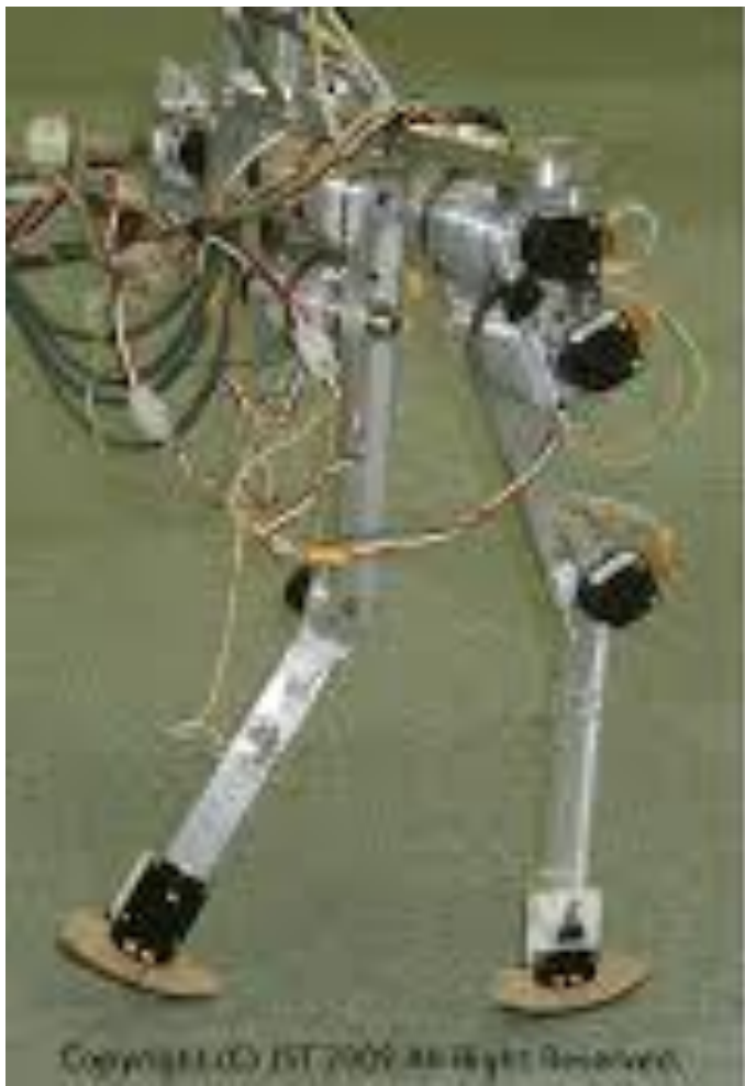
Двуногий робот – пример неполноприводной механической системы
